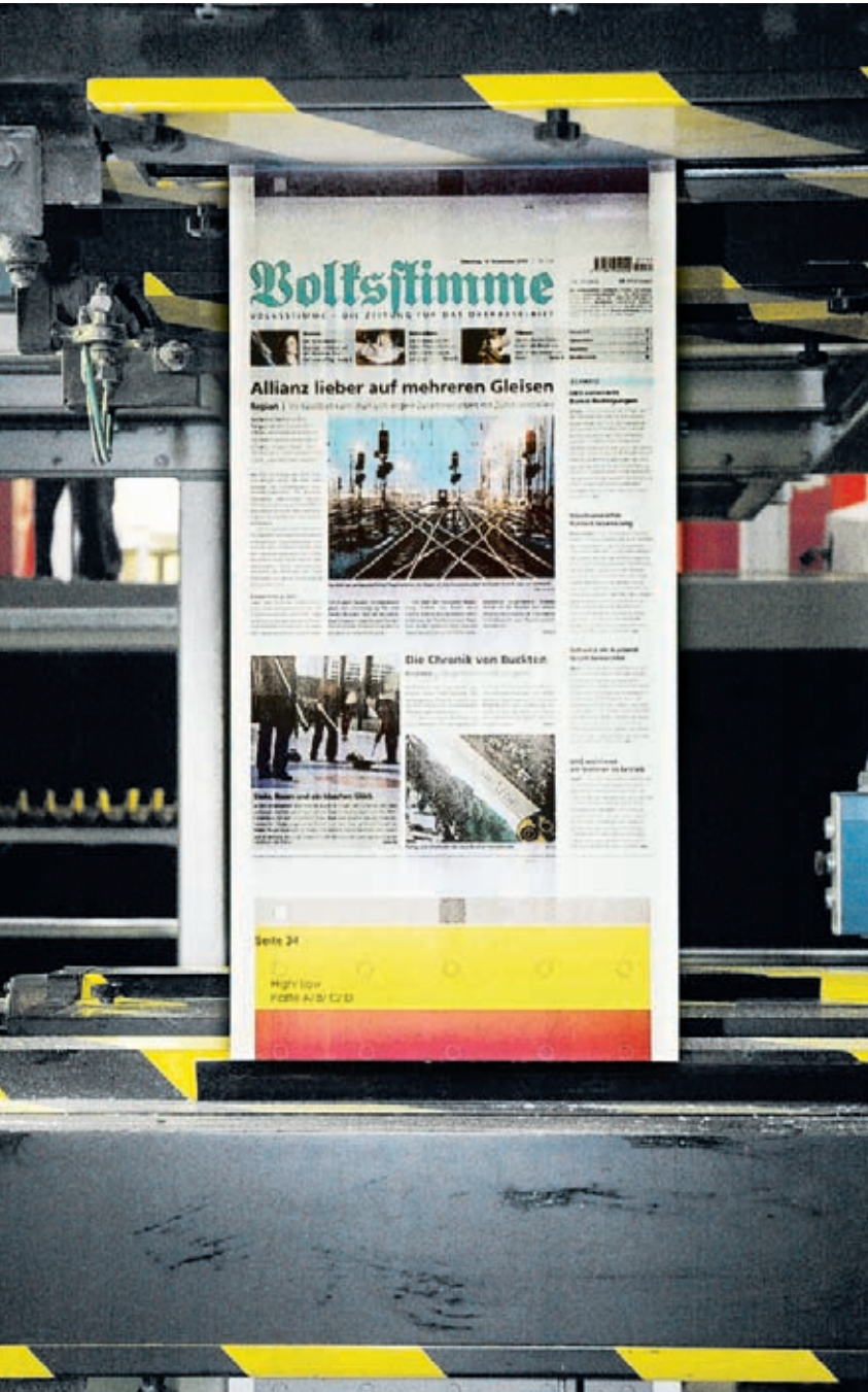
Die Testdruck-«Volksstimme» befindet sich im Falzapparat. Bild Andreas Schwalb
