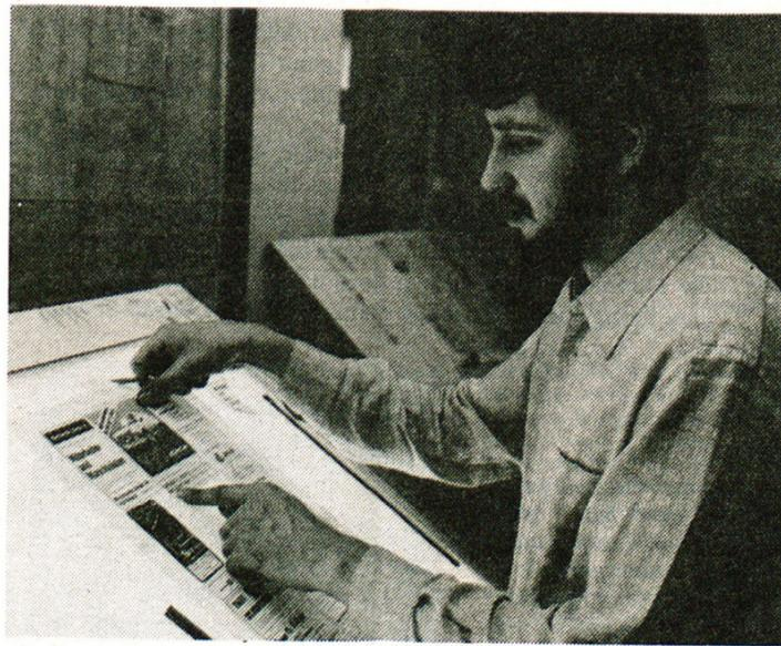
Montage einer Inseratseite. Die Einzelteile bestehen aus Fotosatz, aus gelieferten Schwarzweiss-Vorlagen und Repros von der Reprokamera.
